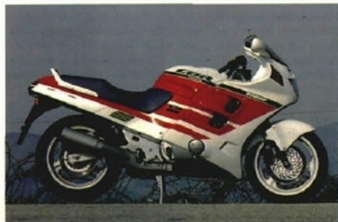
Für den Fahrer bedeutet die Verkleidung eine echte Erleichterung. Nur sein Kopf liegt noch im — allerdings wirbelfreien — Luftstrom. Der Beifahrer wird ab 160 km/h von sehr starken Vorwirbelungen genervt.
