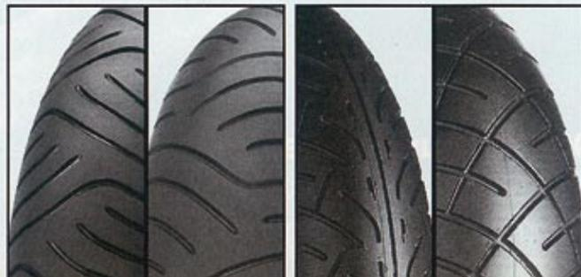
Generationswechsel. Bridgestones Cyrox (rechte Seite) gehörte zur ersten Generation der Radialreifen und ist immer noch Erstausrüstung bei der CBR 1000 F. Der moderne Metzeler ME Z4 (links) verbessert das Fahrverhalten der Honda dramatisch.
