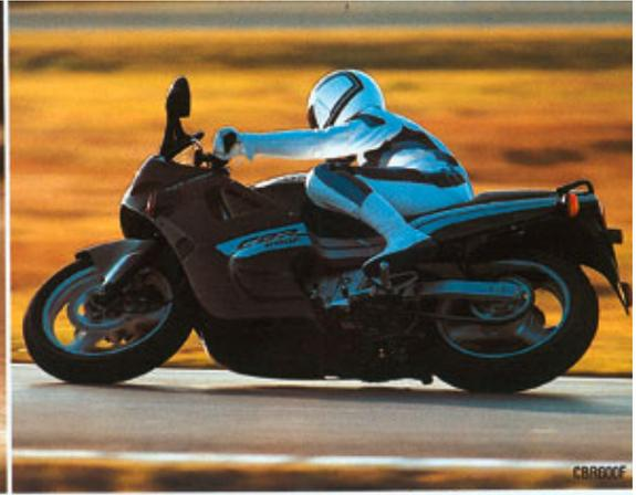
Nicht nur Außeneinflüsse, auch störende Motorabwärme und -geräusche werden durch die Vollverkleidung am Fahrer vorbeigeführt, während gleichzeitig kühle Luft durch die Verkleidung hindurchgeführt wird.
