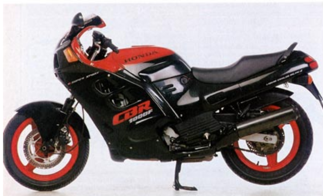
Die CBR-Besatzung ist durch die Verkleidung voll von der Antriebsmechanik abgeschirmt
