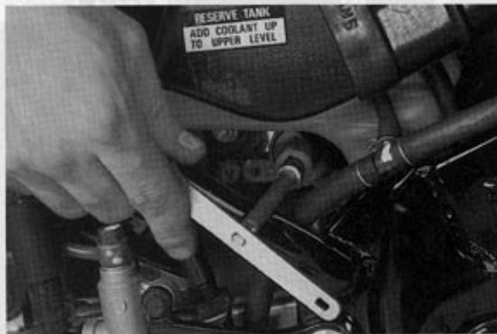
**Oben: Einstellung des Federbeins ist mit dem Bordwerkzeug möglich. Links: Tankstütze vor dem Abheben aushängen. Zum Synchronisieren Tank vorn anheben**
