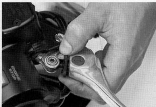
Oben Einstellung des Bremshebelspiels am Lenker, Gelenkstellen gelegentlich schmieren. Unten der Blick auf die Bremszange zur Kontrolle des Belagverschleißes. Der gute Fahrer hat beide Punkte stets im Griff
