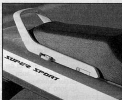
Eine elegante wie praktische Lösung sind die versenkbaren Gepäckhaken am Haltegriff für den Beifahrer
