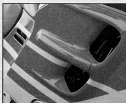
Kleine Seitenspoiler verhindern, daß schon beim einfachen Umfallen der Maschine die Verkleidung verkratzt
