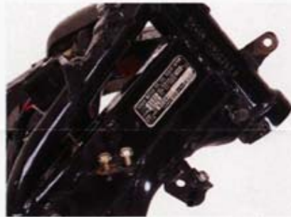
Schwingungsopfer: Der unter dem Steuerkopf verschweißte Halter für die Hupe und Wasserkühler hatte sich losvibriert
