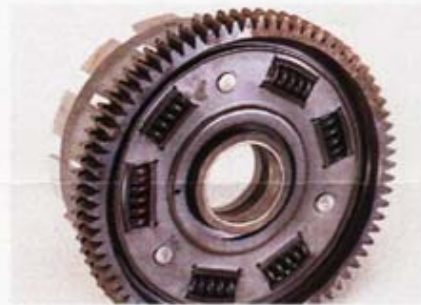
Poltergeist: Fünf Federn im Kupplungs-Ruckdämpfer hatten keine Vorspannung und verursachten Geräusche
