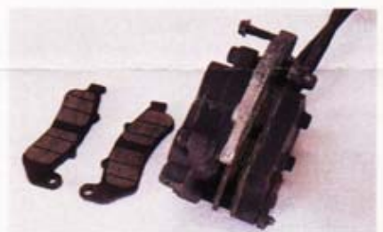
Sauberes Tragbild: Die Bremsbeläge zeigten stets gleichmäßigen Verschleiß
