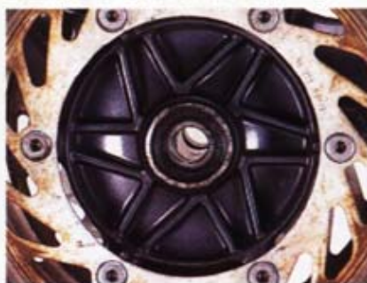
Ausreißer: Bei km-Stand 27900 mußten die Vorderradlager getauscht werden, Korrosion infolge Wassereintruchs
