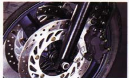
Im Test problemlos: Die Servomechanik des Sekundärbremskreises
