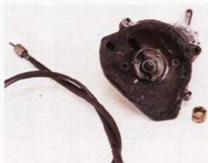
Materialwahl: Das zwischen Ritzelschraube und Tachotrieb sitzende Kunststoffelement war bei km-Stand 42800 am Ende
