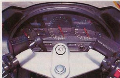
Yamaha: Etwas nach rechts gerücktes Instrumenten-„Brett“ mit zwei Tages-km-Anzeigerollen und rechts unten versteckter Digitaluhr
