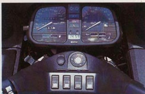
BMW: Klar gezeichnetes Cockpit mit stark gedämpftem Tachometer, Digitaluhr, Ganganzeige und Steckdose
