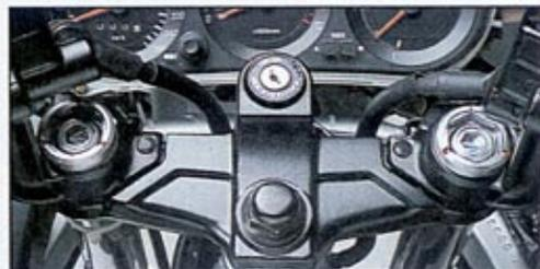
Mit Werkzeug läßt sich die Telegabel in Federvorspannung und Dämpfung verändern
