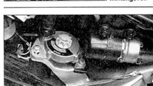
**Yamaha** Alles an einem Ort einstellbar, Federvorspannung und Dämpfung
