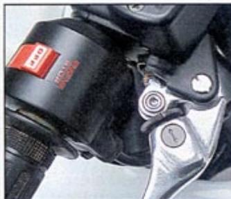
Mittels einer Stell-schraube ist der Abstand zwischen Kupplungs- und Handbremshebel zum Griff variiert
