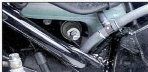
Rechts unterm Seitendeckel kann die Dämpfung des Federbeines dreifach eingestellt werden
